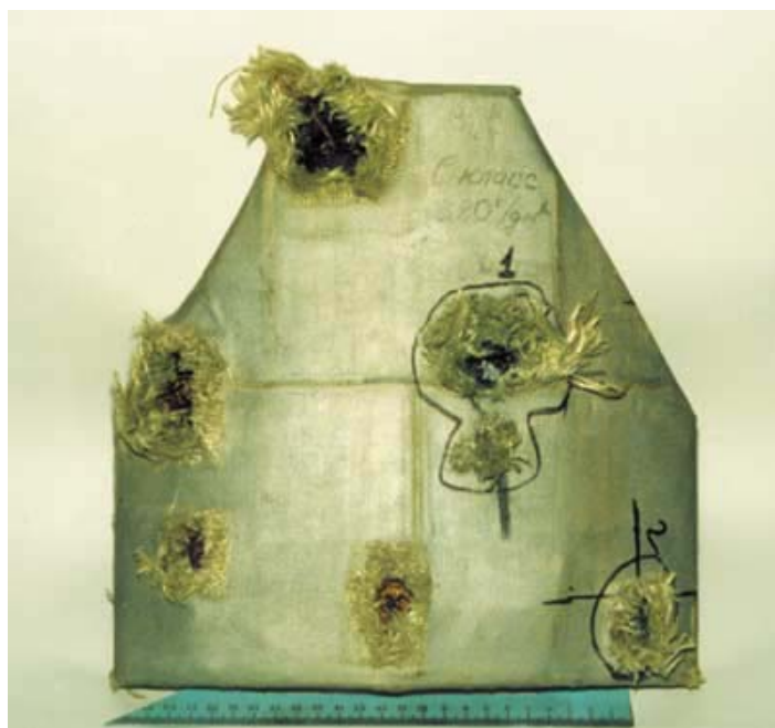
Керамическая панель VI класса защиты из корунда после испытаний
