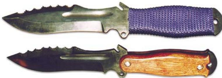
Варианты исполнения боевого ножа «Пластун-1». Нож может иметь деревянные накладки рукоятки или же рукоятка может просто обматываться высокопрочным шнуром. Гарда «Пластуна» более развита и в верхней части имеет щель для гибки проволоки. Внизу на клинке сделан вырез, позволяющий перехватить нож впереди гарды, что удобно при выполнении хозработ
