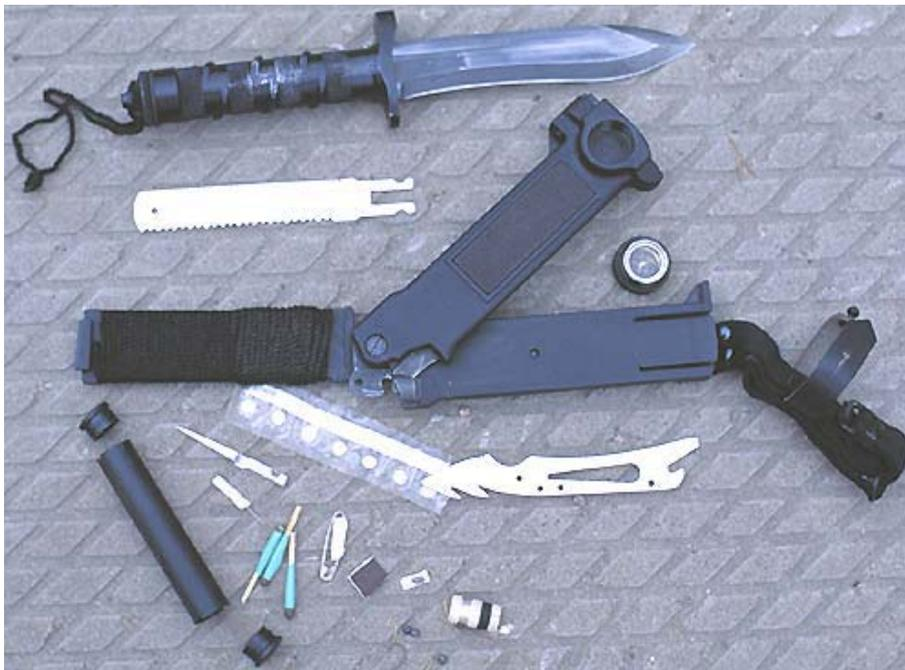
Многоцелевой армейский нож «Басурманин». 1 - нож, 2 - ножны с поворотной пластиной со шнуром и абразивным бруском, 3 - компас, 4 - универсальная ножовка (по дереву и металлу), 5 - гарпун, 6 - шило, 7 - пенал. В комплект выживания входят охотничьи спички, нитки, таблетки для обеззараживания воды, рыболовные крючки, грузила, леска, булавка, кремни, швейная игла.
